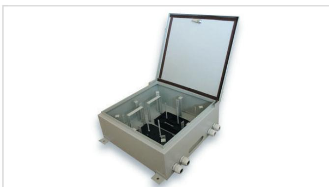
Кросс-муфта ёмкостью до 832 соединения, используется со всеми типами волоконно-оптических кабелей. Возможна установка до 26 кассет по 32 соединения. Кабели закрепляются с помощью пластиковых стяжек, центральный силовой элемент или броня закрепляется жёстко к корпусу Кросс-муфты. Возможен одновременный ввод более 8 кабелей.
